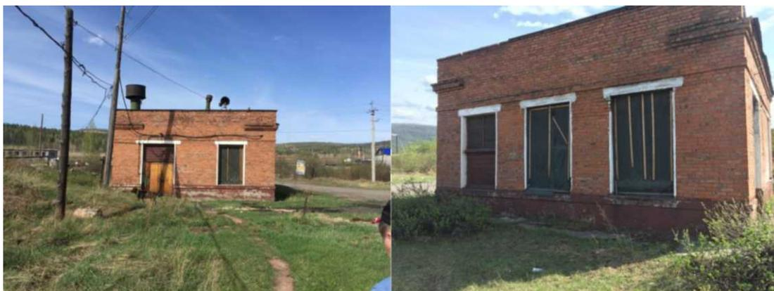
В подземной части КНС располагается приемный резервуар и машинное отделение. В надземной части сооружения располагаются грабельное отделение, щитовая, венткамера, подсобные помещения. Постоянного присутствия персонала не предусмотрено. Отопление отключено, требуемые параметры по вентиляции сооружения не обеспечены, водоснабжение отсутствует.
